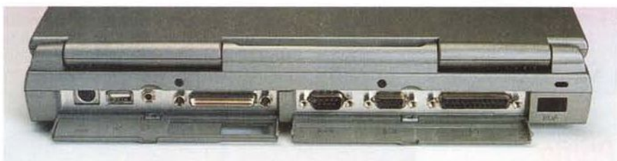
Ben protette da due coperchi basculanti separati, tutte le porte per la connessione con il mondo esterno sono naturalmente posizionate sul retro dell'Enface (fatta eccezione per le prese audio ed il modem). Uno sportellino scorrevole incorporato nel coperchio sinistro consente l'eventuale accesso, anche alla sola porta proprietaria per il collegamento del portatile ad una Dockbay. Nello stesso vano sono posizionate la porta PS/2, per il collegamento di uno tra mouse e tastiera esterni, la porta USB e una pratica uscita video PAL. Sotto il coperchio di destra sono visibili le porte parallela, seriale e D-Sub VGA per il collegamento ad un monitor esterno.
